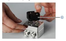
Fig. 39: Positioning piston guide
