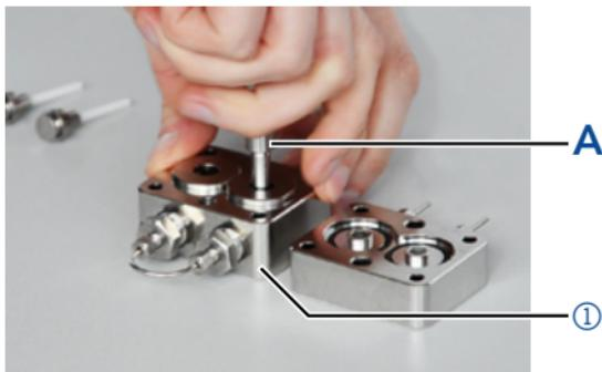
**Abb. 16:** Entfernen der Dichtungen (Hochdruckseite)
