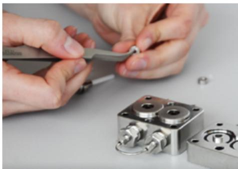
**Abb. 13:** Trennen von Stützring und Einstellring
