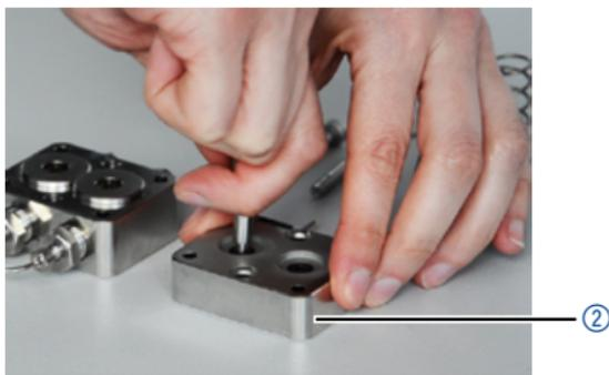
**Abb. 17:** Entfernen der Dichtungen (Niederdruckseite)
