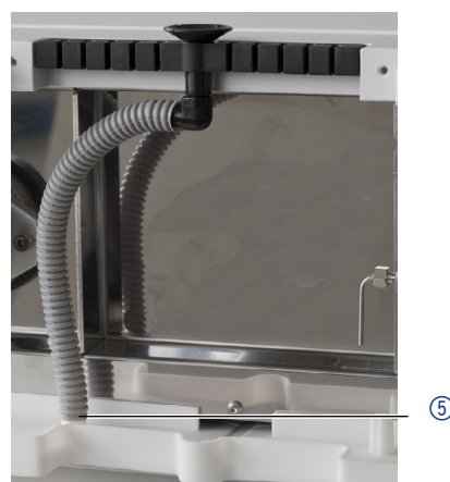
Fig.5 Tuyau connecté à l'appareil
