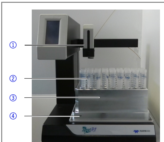
Abb. 1 Beispiel einer Kühlung nach Abnahme der Haube
