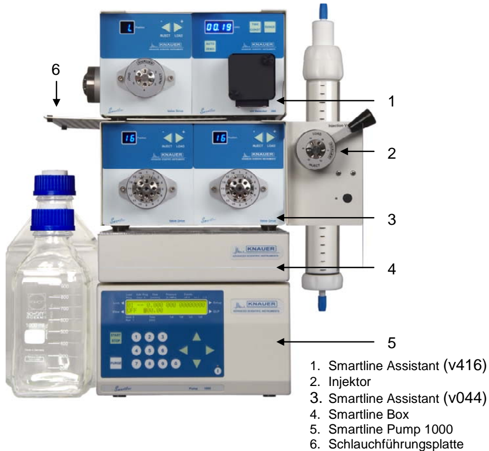
Abb. 1 Frontansicht des GPC-Probenreinigungssystems 6500
