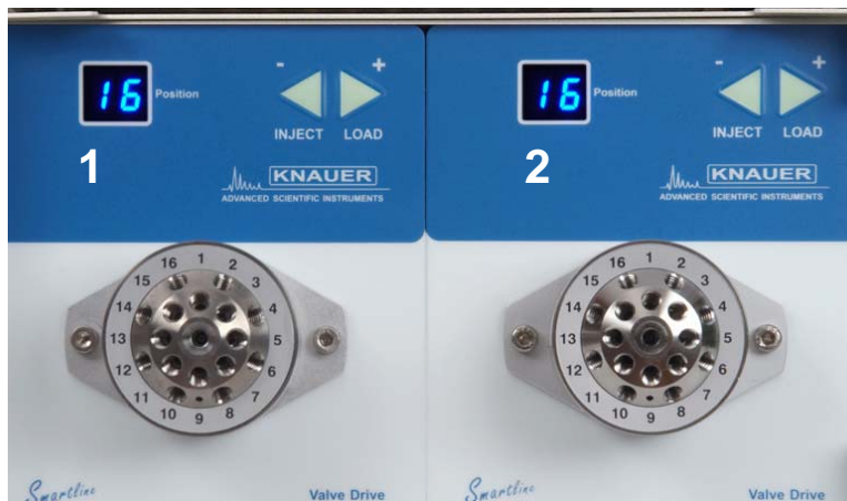
Abb. 3 Frontansicht des Smartline Assistant 6000 (A5003V044), mit: 1 17-Port-1-Kanalventil für die Probenschleifenschaltung 2 17-Port-1-Kanalventil für die Probenschleifenschaltung
