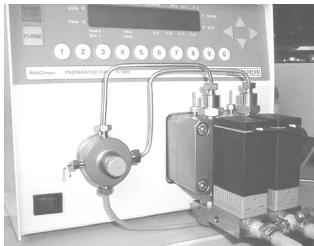
Abb. 18 Binärer LPG Ventilblock an der Preparative Pump 1800 montiert
